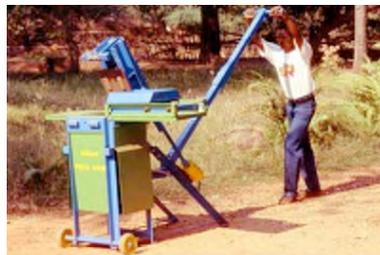
Aaram press 3000 - Multimould press (16 moulds)
